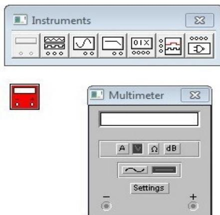
Vrsta merenja bira se tako što se klikne na odgovarajuću dugmad(ovde je izabrana horizontalna crta simbol za jss)Biranje odgovarajućeg mernog opsega vrši se automatski.Pritiskom na dugme Settings otvara se dijalog koji omogućuje da se promene otpornosti ampermetera i voltmetra,struju koja prolazi kroz komponentu i sl.
