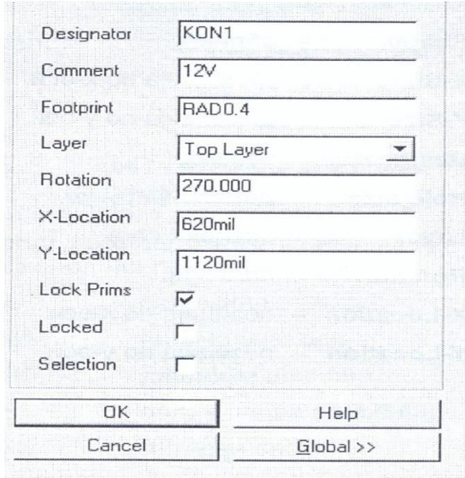
U prozoru Layer menja se aktivni sloj za komponentu.Zapis koji se odnosi na oznaku odnosno vrednost komponente,moguće je menjati samostalno,ako je on vidljiv na pločici(ovo se odnosi na bilo koji String).Zapis je vidljiv ako je opcija **Hide** isklučena.Na slici ispod za Reduktor napona komponente su VIDLJIVE.
