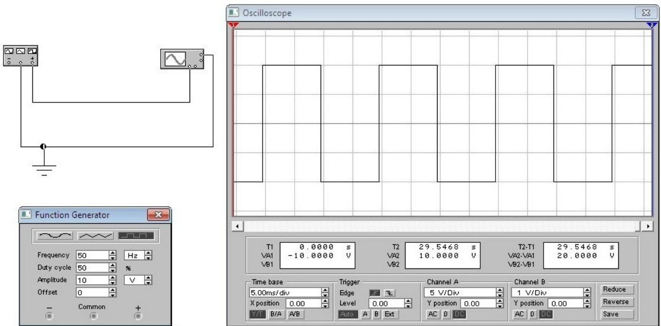
Kada se uključi glavni prekidač pravougaoni impuls se brzo kreće preko ekrana, zauštaviti ga sa Pause. Pritisnuti dugme Expand da slika zauzme ceo ecran osciloskopa.
