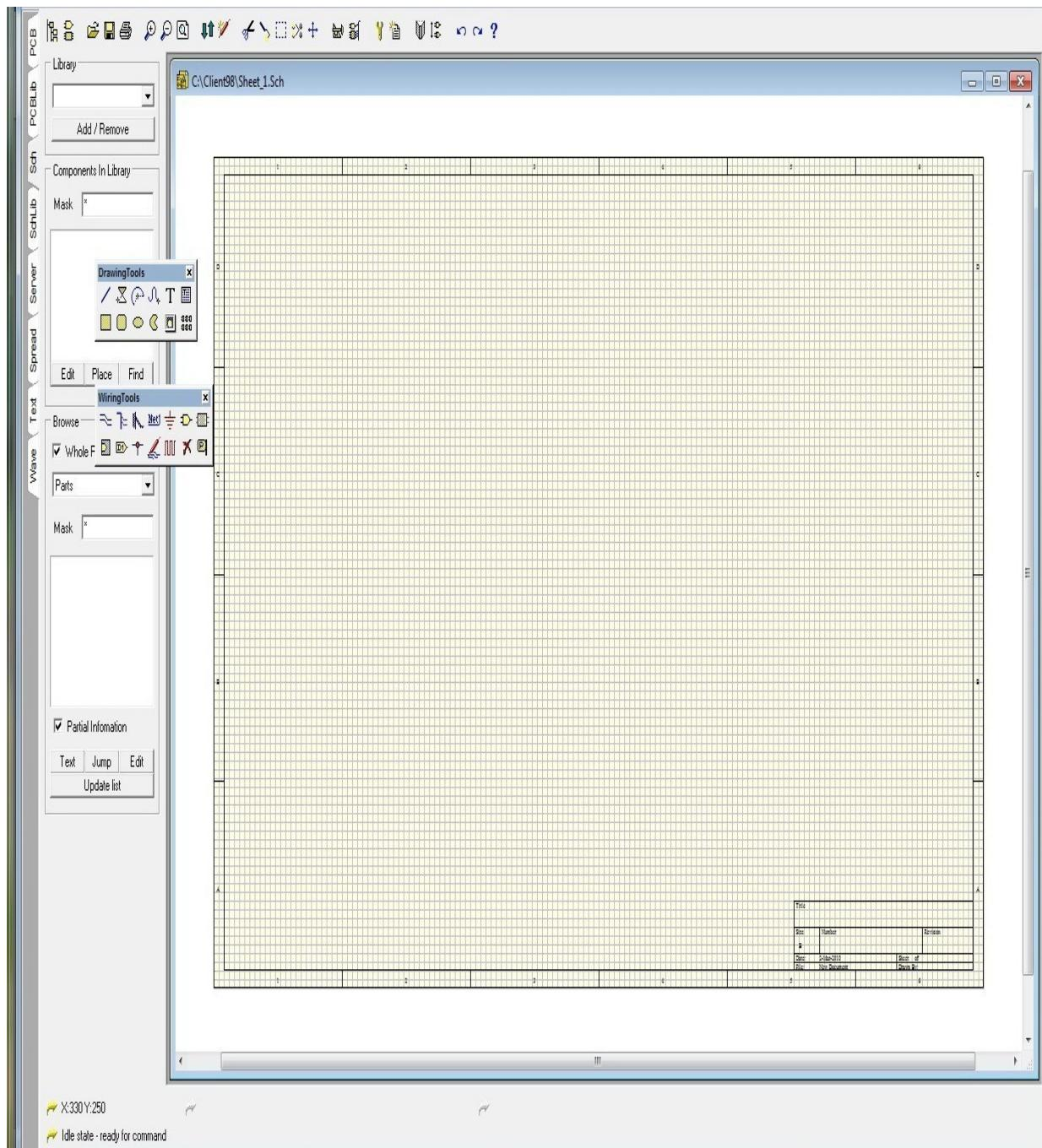
Otvara se radni list sa propratnim radnim okruženjem kao na slici. **Paleta sa alatom Main Toolbar proširen je i sadržajem alatki za otvaranje, snimanje dokumenta, kopiranje i premeštanje.** Panel sadrži i biblioteke **Driving tools** i **Wiring tools** u posebnim prozorima. Postavljanjem miša iznad određenih ikonica videti njihov sadržaj.
