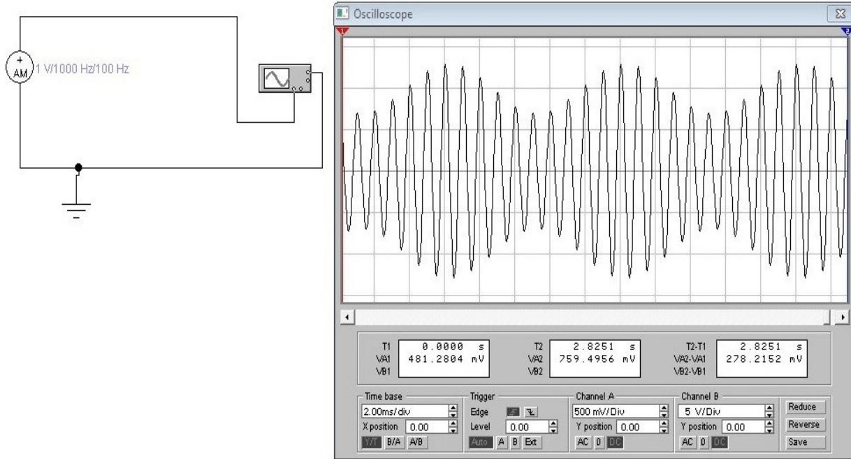
**AM signal po difoltu ima Učestanost nosioca od 1000Hz,učestanost modulišućeg signala 100Hz i dubinu modulacije m=1.Kliknite dva puta na AM generator i podesite dubinu modulacije na m=0.3,slika iznad.**
