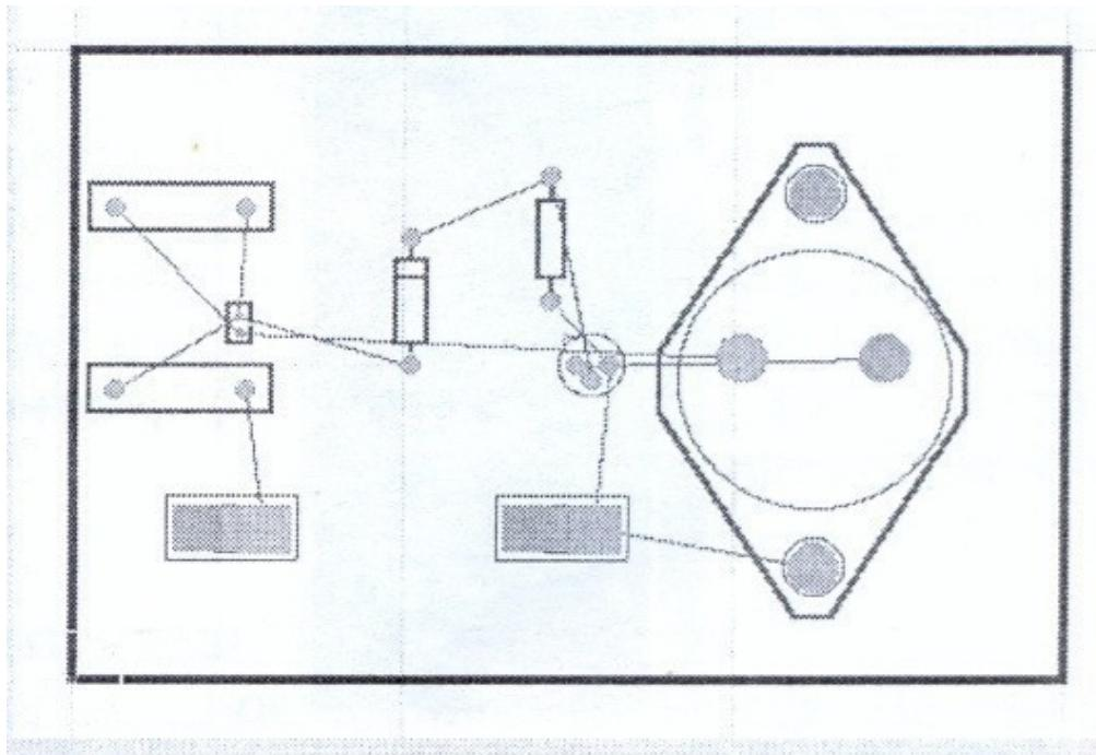
**Ručno razmeštanje komponenti** vrši se komandom **Edit>Move>Component** levim klikom miša na komponentu koju treba premestiti na drugo mesto ili prevlačenjem komponente pomoću miša. Komponenta se rotira tasterom **SPACE**
