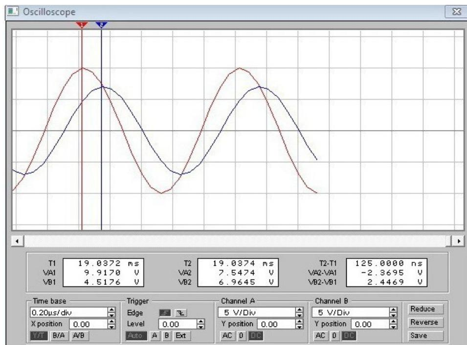
Napon veće amplitude (na krajevima veze) je U, a manji U<sub>c</sub> je napon na kondenzatoru. Fazni pomeraj je:
