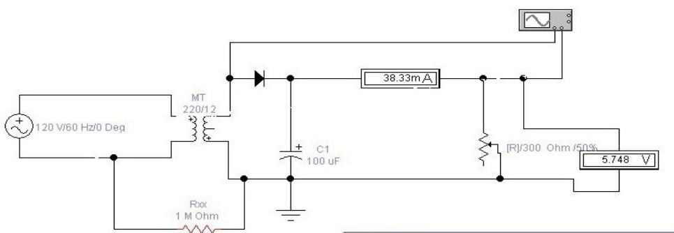
Kliknite dva puta na mrežni transformator..U dijalogu Transformer Properties kliknite na Models pa na biblioteku **powrvolt**.Oznake svake komponente počinju sa PP.Kliknite na onaj sa najpričinjijim karakteristikama,a ako takvog nema ,kliknite na EDIT i unesite potrebne vrednosti:
