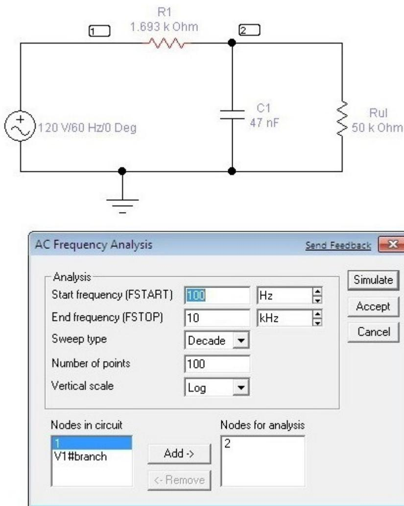
Otvorite meni **Analysis** i u njemu kliknite na **AC Frequency**. Na ekrenu se pojavljuju dijalog prozor(slika iznad) Tu su izvršena sledeća podešavanja:
