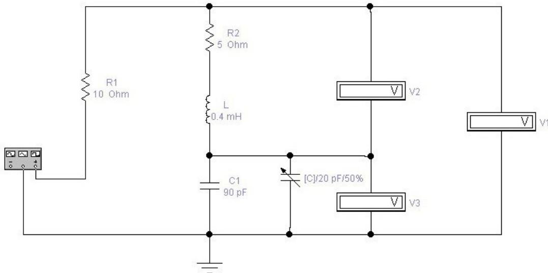
Generator funkcija podesiti da daje sinusni napon učestanosti **800kHz**,amplitude do **5V**.Startujte AC analizu.Podesite:FSTART na 700kHz FSTOP 900kHz Vertical scale :linear.Prebacite čvor 4 u desni prozor komandom add,pošto predhodno označite čvor 5 u levom prozoru,a čvor 1 koji je bio u desnom prozoru izbrišite.Pritisnite **SIMULATE-**.
