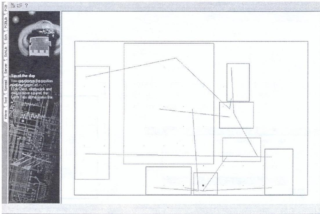
**UNOŠENJE ODABRANOG RASPOREDA NA PLOČICU VRŠI SE KOMANDOM **Update PSB**** iz File menija Global Placer Server(kada je aktivan Plc dokument).**Rezultat unošenja za reduktor napona** iz dokumenta
