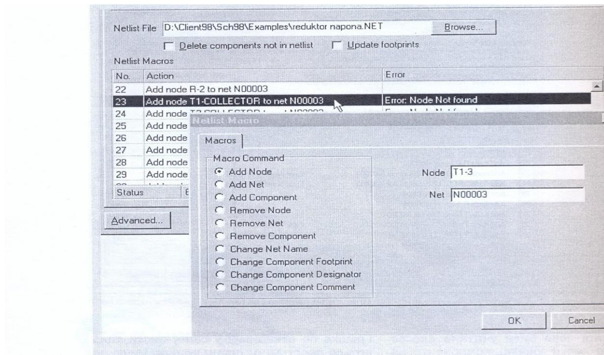
Nakon ispravke svih grešaka aktivirati taster **EXECUTE**. Ovim se sve komponente prenose na pločicu. Veze između priključaka raznih komponenti(PADOVA) prikazane su pomoćnim vezama.
