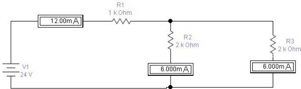
Ampermetar kroz R1 pokazuje 12mA,a kroz R2 i R3 po 6mA.Dakle važi prvi Kirchhoffov zakon.Proverite šta će se dogoditi ako priključite izvor naizmeničnog napona AC Voltage Source .Ne zaboravite da ampermetre prebacite na AC.
