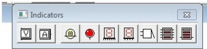
1. **VOLTMETAR** se koristi za merenje jednosmernog napona ili efektivne vrednosti naizmeničnog napona između tačaka. Deblja strana pravougaonika oznake voltmetra predstavlja negativni priključak. Specifikacija rada postiže se tako što se dva puta klikne na sliku voltmetra. Otvara se dijalog Voltmeter Properties
