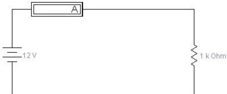
Klikom na glavni prekidač, ampermetar će da pokaže struju jačine od 12mA,što je tačno i po Omovom zakonu: $I=U/R=12/10000=12mA$ ,čime smo proverili Omov zakon,slika dole.
