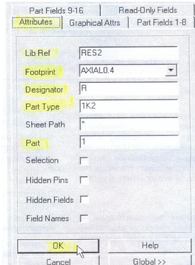
Na slici su prikazani podaci za otpornik RES2. Na radnom listu biće vidljivi samo Designator i Part Type. Za primer reduktora napona šema izgleda kao na slici dole
