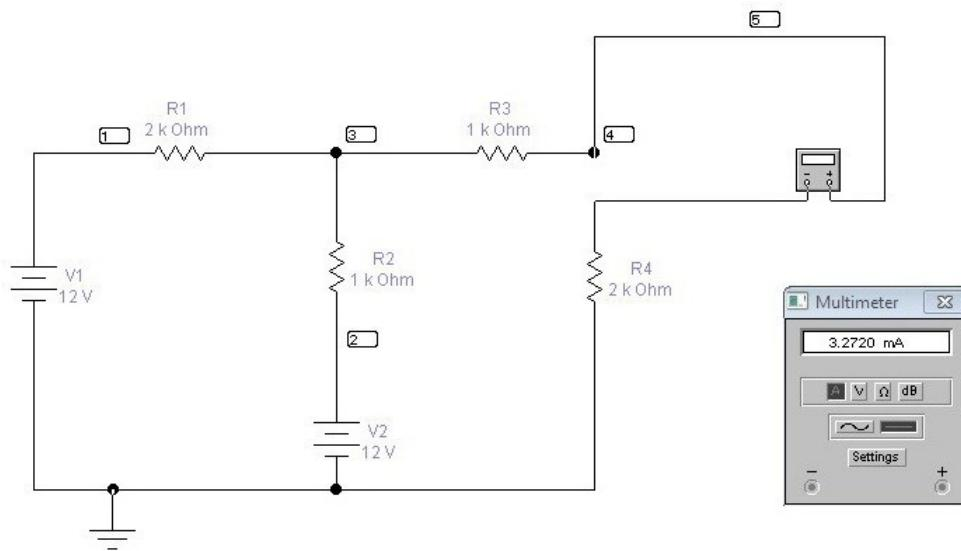
Redni brojevi čvorova na slikama mogu da se izbrišu,tako što se desnim dugmetom klikne na prazno mesto na crtežu.Pojavljuje se pop up meni na kome treba kliknuti na Schematic Options,zatim na Show/Hide i odčekirati Show Nodes.Naizmenični napon i struja mere se na isti način ,samo što na multimetru treba kliknuti na dugme sa sinusoidom.
