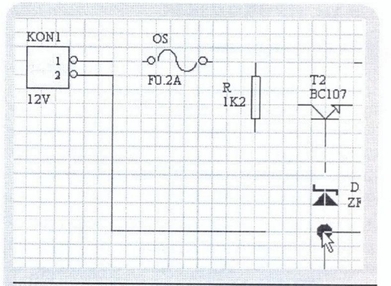
Editovanje provodnika ostvaruje se dvostrukim klikom na provodnik,čime se otvara **dijalog prozor Wire** u kome se definiju debeljina **Wire width** i boja provodnika **Color**,a moguće je i selektovati provodnik.Posle spajanja svih komponenti dobijena je sledeća šema:
