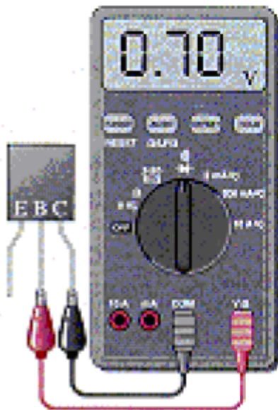
Slika Direktno polarizovan spoj baza-kolektor Slika Inverzno polarizovan spoj bazakolektor
