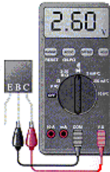
Slika Direktno polarizovan spoj baza-kolektor Slika Inverzno polarizovan spoj bazakolektor
